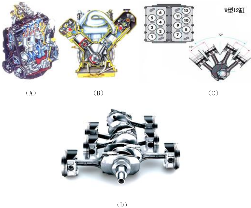
(A) 直列型发动机；(B) V型发动机；(C) W型发动机；(D) 水平对置型发动机
