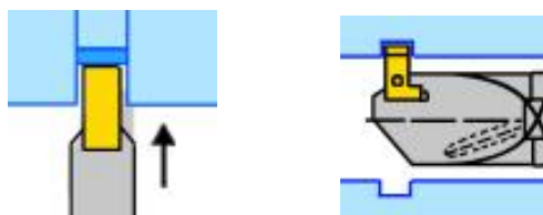
(a) 外槽刀（切断刀） (b) 内槽刀
