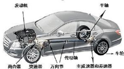
图 1-1-2 汽车传动系统的组成
