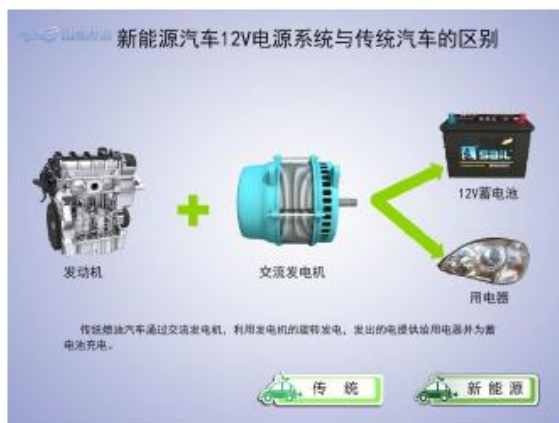
图 1-1-3 新能源汽车 12V 电源系统与传统汽车的区别
