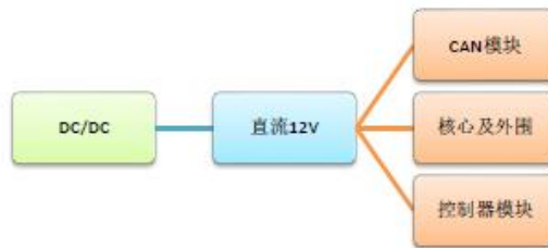
图 1-1-1 辅助电源 DC/DC 模块框图
